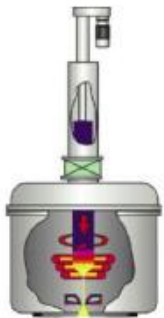
Elektróda indukciós olvasztása vákuum térben, inert gáz atomizáció (EIGA)
