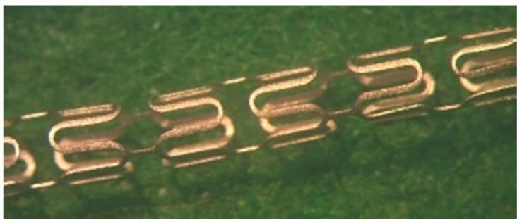
16-14. ábra – Lézeres-litográfias levilágítással és kémiai maratással készített sztent prototípusok; egy BME-s diplomázó magyar diák, Nyitrai Zsolt alkotása 2002-ben
